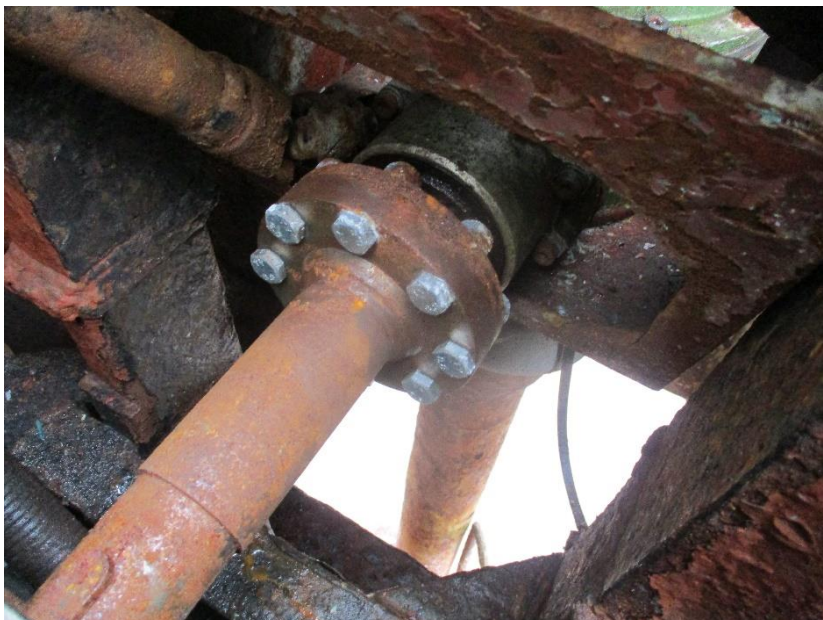
Foto Nr. 97, verrostete Antriebswelle und verzinkte Schrauben am Eingang des SRPs
