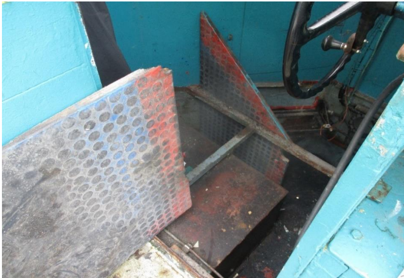
Foto Nr. 79, verschmutzter und verschlissener Boden im Steuerhaus
