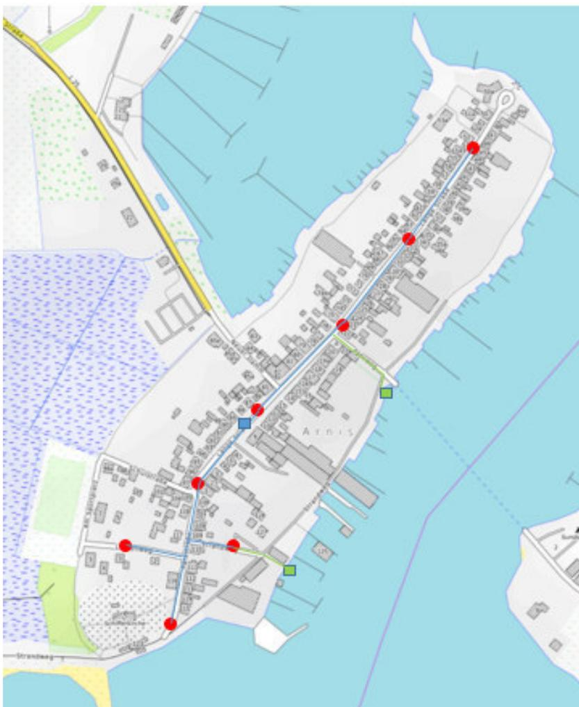
Abbildung 3: Konfiguration einer separaten Löschwasserleitung (blaue und grüne Linien) mit Entnahmestellen / Hydranten (rote Kreise) und Einspeisungspunkten (grüne Rechtecke – Standorte für Entnahmestation für zentrale Schleiwasserentnahme, blaues Rechteck – Brunnen für Variante III)
