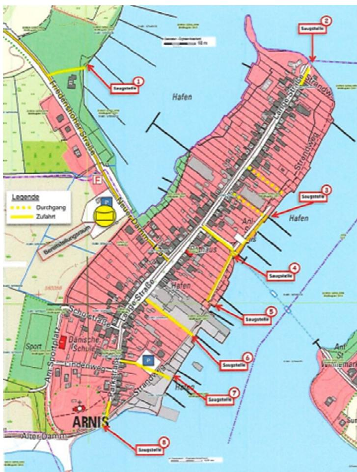
Abbildung 5: Aktuell genutzte Saugstellen 1 bis 8 der Feuerwehr Arnis
