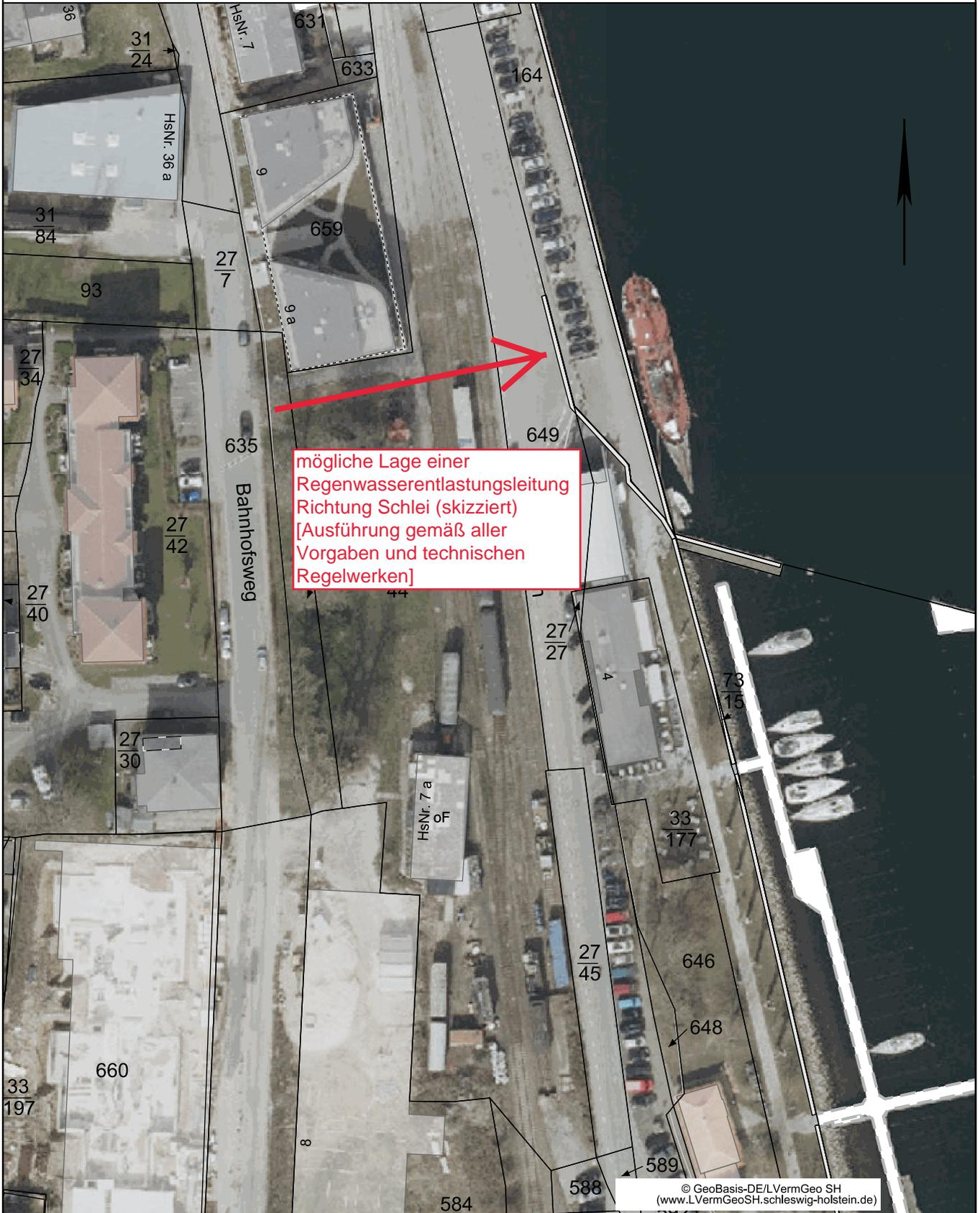
mögliche Lage einer Regenwasserentlastungsleitung Richtung Schlei (skizziert) [Ausführung gemäß aller Vorgaben und technischen Regelwerken]
