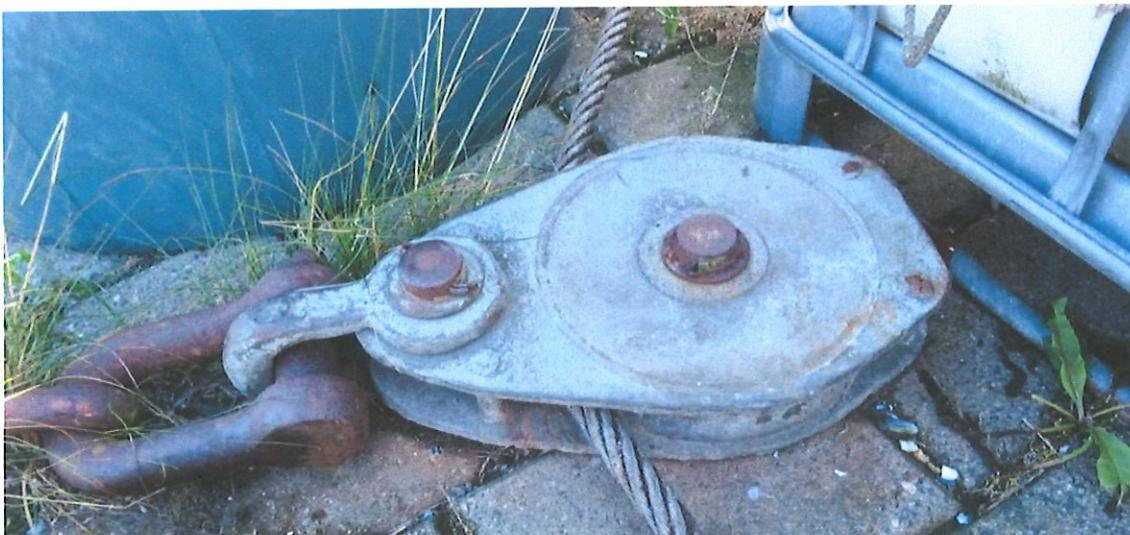
Bild 2: passender Durchmesser von Umlenkrollen
