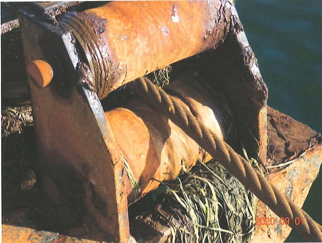
Bild 1: zu kleiner Durchmesser der Umlenkrollen mit Riefenbildung
